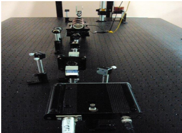
Figura 8 Fotodetector Balanceado instalado en arreglo óptico
